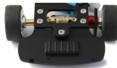
**3.5.- Tornillería :** llibres y únicamente metálicos , tanto en el caso de los tornillos de sujección de subchasis y carrocería como en el caso de los usados entre chasis y subchasis.
